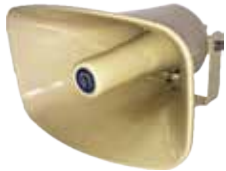
■トランペットスピーカー NP-550 サイズ: 口径360×225mm/D320mm 重量: 約3.5kg 定格入力: 50W インピーダンス: 16Ω
