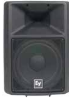
■SRスピーカー エレクトロボイス SX300 サイズ: W429×D312×H586mm 重量: 14.5kg タイプ: 2WAYフルレンジ 許容入力: 300W インピーダンス: 8Ω
