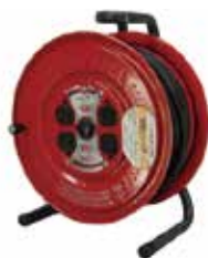
■電工ドラム各種 電線仕様 (電線種×太さ×芯) : VCT1.25×2 電線許容電流：15 (4口合計で) コンセント数：4 2P・15A・100v
