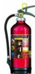
■消火器 (10型) サイズ： 直径117.4×H481mm 薬剤量：3kg 総重量：約5.1kg 放射時間：約14秒 距 離：3～5m ※4型・20型もあります
