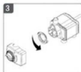
中にあるロック用リングを半時計回りに回して取外してください。
