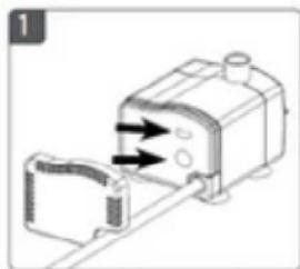
ウォーターポンプの後ろ部分のカバーを引っ張って取り外し、水とブラシで掃除してください。必要に応じ、台所用液体洗剤を薄めた溶液を使用してください。このメンテナンスは毎週行ってください。
