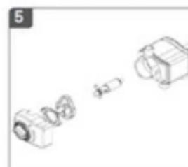
羽車部品を取外し、台所用液体洗剤と水で洗浄してください。
